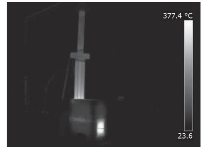
Termografía de la estufa durante los ensayos, realizada en simultáneo al ensayo de evolución del rendimiento y monóxido de carbono.
