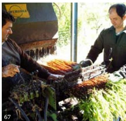
[66] Descortezado de mimbre con máquina con carretilla hidráulica. Francia.
