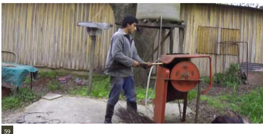
Las varas introducidas por puñados dentro la rendija frontal son traccionadas hacia el interior por el movimiento de rotación que generan los ganchos. Este sistema obliga al productor a mantener una postura erguida y firme, con los brazos levemente flexionados y en constante movimiento de tracción y rotación para el pelado parejo del mimbre.
