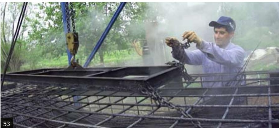
[53] Descarga del canasto. Se deben desenganchar las sujeciones del canasto que salen del agua hirviendo. No se usan EPP. Región Delta.
