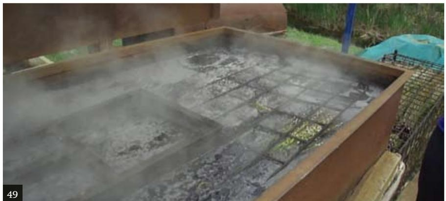
[50] La caldera se tapa con unas chapas mediante un sistema de contrapesos. Al hervir el agua, ésta rebalsa por la parte trasera de la caldera. Región Delta.
