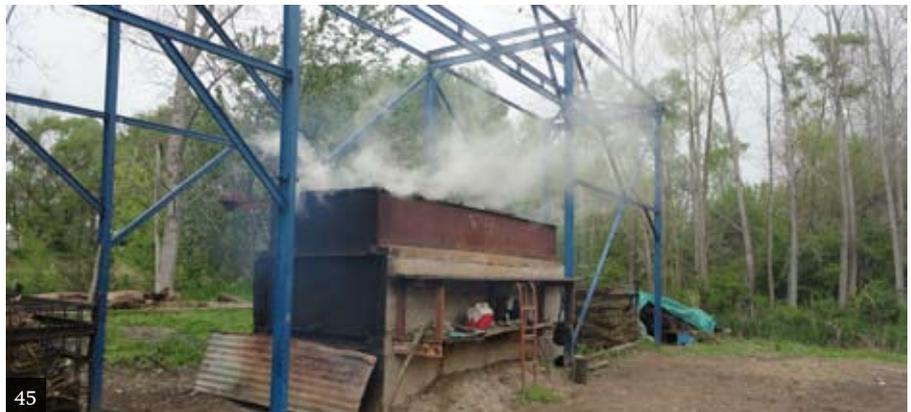
Este sistema, a diferencia de la caldera simple, permite cargar 1400 kg de mimbre en la caldera, de manera asistida, disminuyendo el riesgo de que el productor entre en contacto directo con el agua hirviendo.
