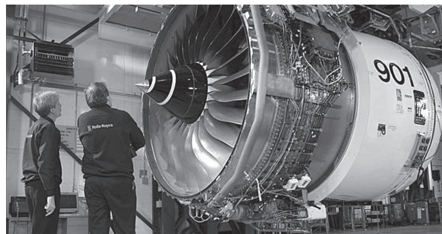
Figura 15: Motor Trent 900 de Rolls-Royce®, para el A380.
