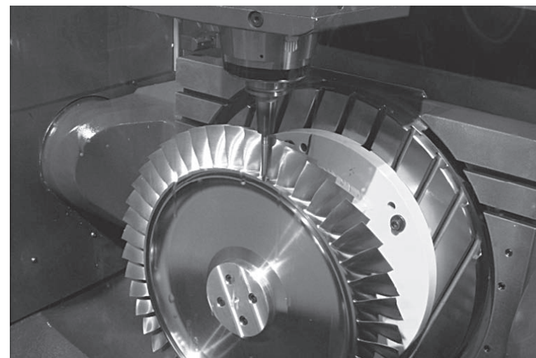
Figura 20: Fresado de un rotor integral (Blisk, blade-on-disk) en una fresadora de cinco ejes
