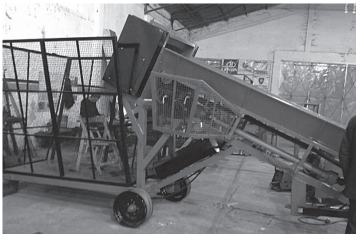
Figura 7: Máquina para recoger mate tras ser cortado por pinzas neumáticas (empresa Jensen, Resistencia)
