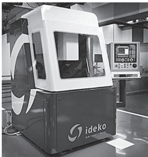
Figura 31: Fresadora de ultraprecisión para piezas micro, del centro vasco IDEKO
