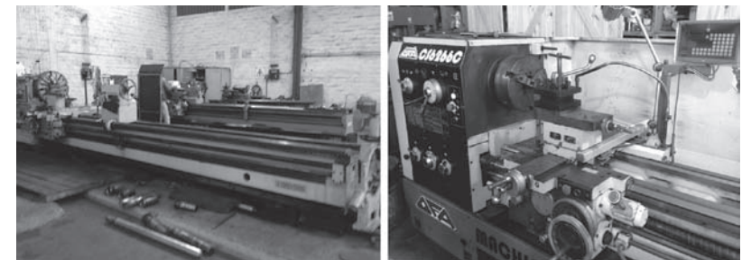
Figura 4: Tornos de reciente adquisición, a) sin reglas de medida y b) con reglas
