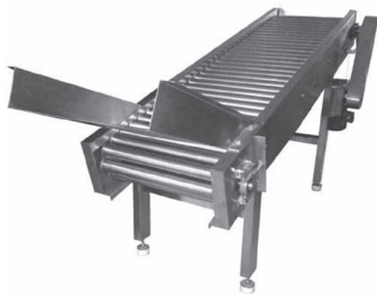
Banda de rodillos para selección de fruta fresca
