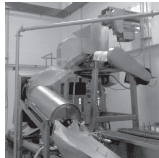
Sistema de extracción de pulpa de maracuyá por trompos
