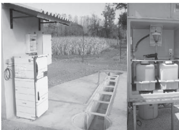
Foto 24: Canal de medida del caudal con el flujo metro y tomador de muestras
