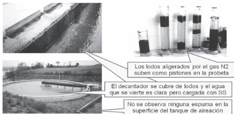
Fotos 40 a 42: Observaciones del fenómeno de desnitrificación
