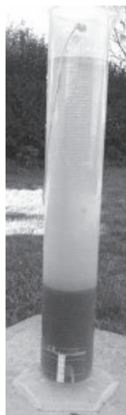
Foto 18: Test de decantación de los lodos en una probeta transparente de 1 litro
