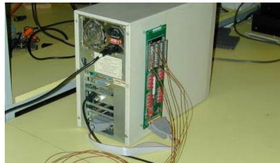
Fig. 1. Sistema remoto de medición de temperatura.
