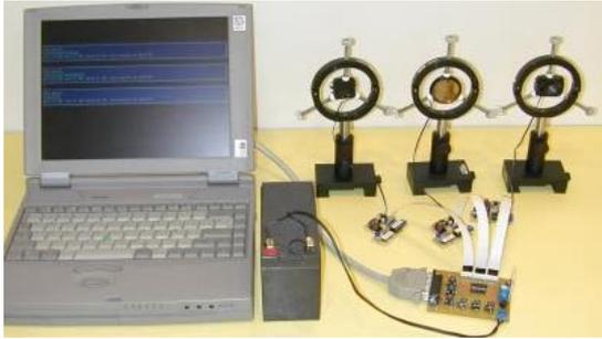
Fig. 2. Detección de colisiones con sensores ultrasónicos.
