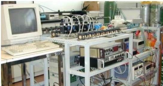
Fig. 3. Banco de mezcla de gases.
