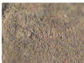
Fig. 1: Capa de cobre electrodepositada y sometida a ultrasonido – Amplificación: X 100
