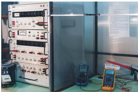
Cámara para medición de resistencia de aislamiento y rigidez dieléctrica, e instrumental asociado de generación y medición
