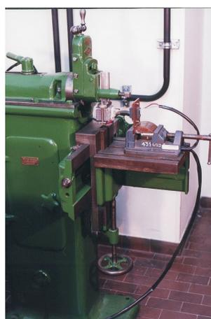
Dispositivo para ensayo de fatiga
