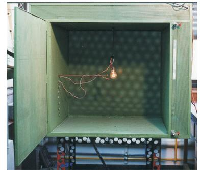
Recinto a prueba de corriente de aire para ensayo de lámparas
