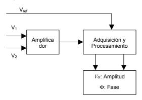
Figura 1: Diagrama en Bloques simplificado del microVoltimetro vectorial
