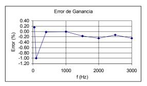
Figura 5:Error de ganancia del detector.
