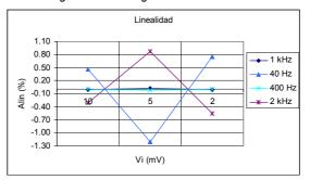
Figura 6: Linealidad de Alterna del detector.
