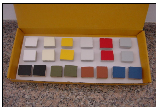
Fig. 2: Muestras utilizadas para determinar la absorbanza solar a través de mediciones espectrofotométricas.
