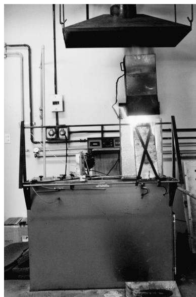
Ensayo de propagación de llama
