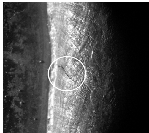
Figura 4. Fisuras en el cordón de soldadura.
