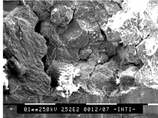
Figura 12. Detalle de la zona de fractura intergranular.
