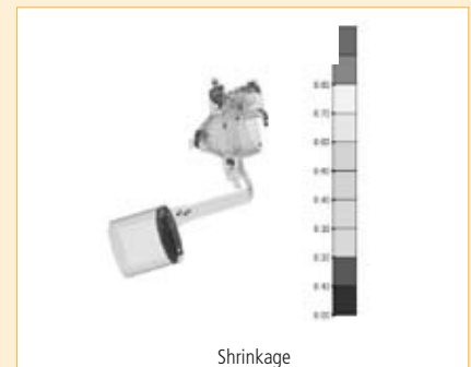
SHRINKAGE | Muestra luego de solidificado posibles zonas de porosidad por contracción.
