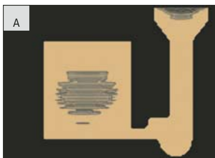
La figura A muestra las zonas probables de porosidad por contracción, productos de una colada virtual por gravedad.
