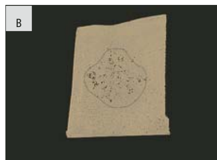
La figura B muestra las zonas de porosidad por contracción, productos de una colada real por gravedad.
