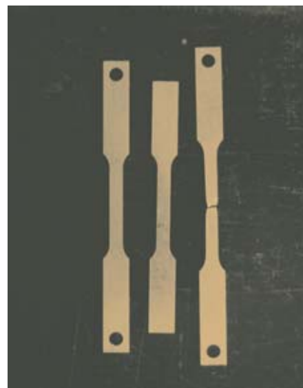
Distintas probetas de tracción de chapa fina de acero galvanizado: a. sometida a tracción b. obtenida por corte láser c. por mecanizado
