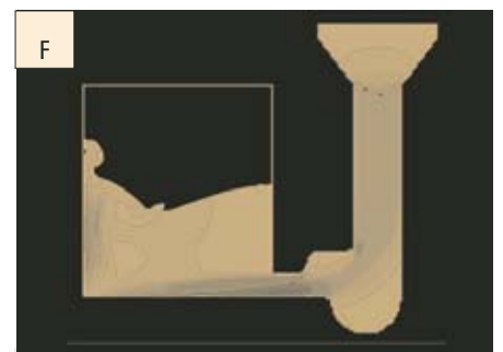
Las figuras C, D, E y F muestran una secuencia de llenado de un molde durante una colada virtual por gravedad.
