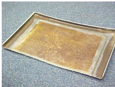
Mercedes A-200 Componente de auto, fabricado por vacío lino /PU-espuma
