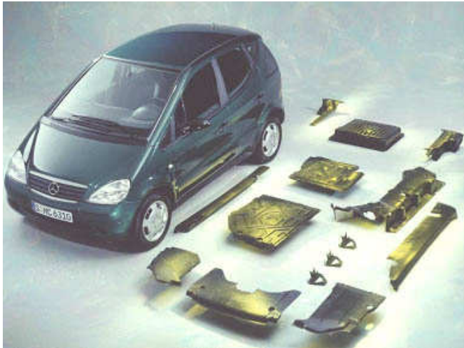
Mercedes A-200 Componente de auto, fabricado por vacío lino /PU-espuma
