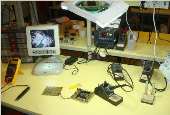
Inspección y estación de soldadura SMD y rework
