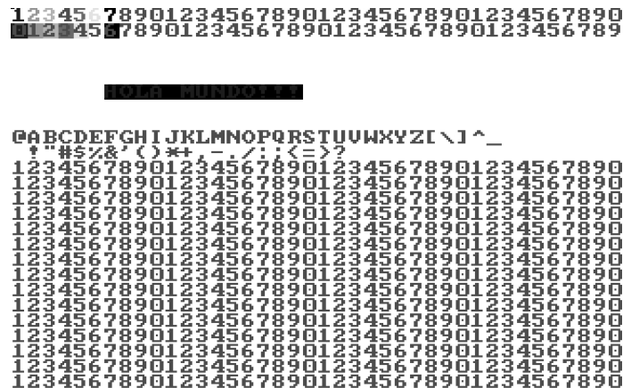
Fig. 1. Imagen obtenida luego de procesar la información generada por el banco de prueba. La misma predice la imagen obtenida al conectar la FPGA a un monitor VGA
