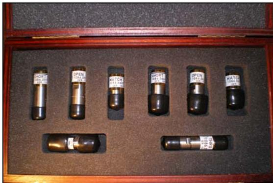
Figura 2: Kit de calibración para TOSM.
