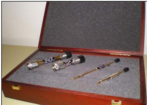
Figura 3: Kit de calibración para TRL.
