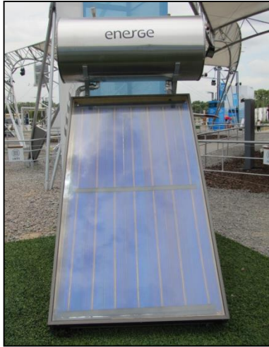
Figura 2: Equipo de fabricación nacional, actualmente bajo ensayo según lineamientos ISO 9459-2
