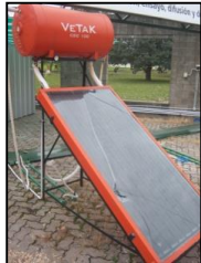
Fig. 4 y 5: Rotura de vidrio (sin templado), Figura 5: salida de agua caliente con oxido de hierro (tanque de hierro con aplicación de recubrimiento epoxi mal aplicado)
