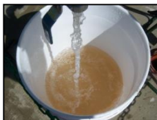
Fig. 4 y 5: Rotura de vidrio (sin templado), Figura 5: salida de agua caliente con oxido de hierro (tanque de hierro con aplicación de recubrimiento epoxi mal aplicado)
