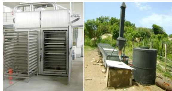
Figura 1. a. Vista secadero-ahumadero, INTI-MdP. b. Vista del secador solar híbrido de túnel, Kenia.
