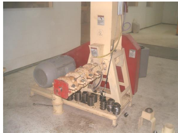
Figura 1: Extrusora Instapro, planta piloto INTI – Cereales y Oleaginosas.
