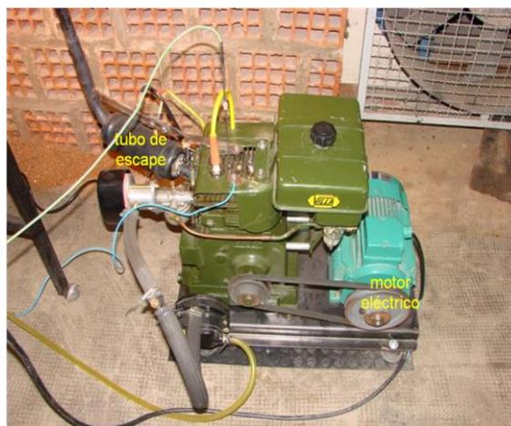
Figura 2: motor adaptado para funcionar con varios combustibles: nafta, GNC y GNC-H<sub>2</sub>.
