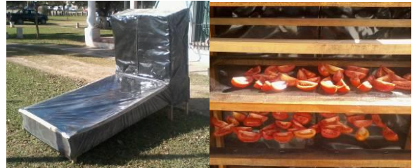
Figura 2: Fotografías de la réplica del secador Don Bosco que se utilizó para su evaluación.
