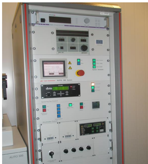
Figura 1: Equipo de “sputtering”.
