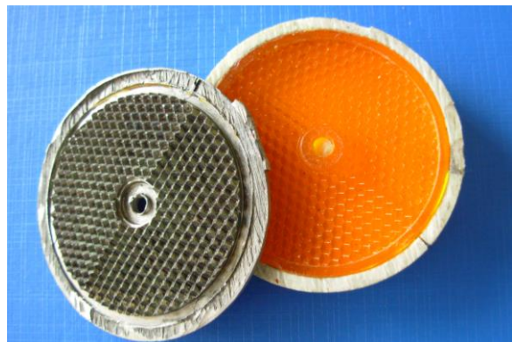
Figura 7: Prototipo y molde realizado por electroformación con níquel.
