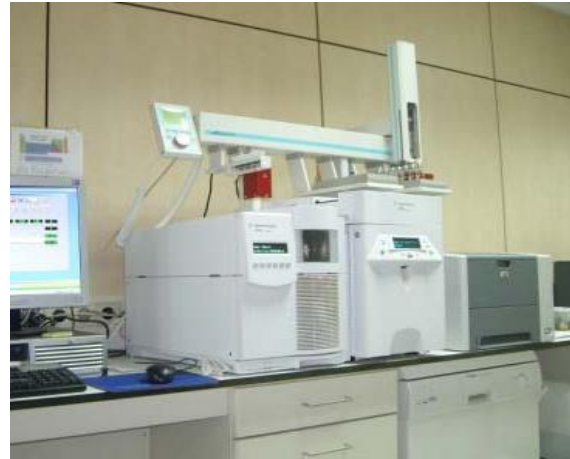
Figura 2: Cromatógrafo Gaseoso con Detector Selectivo de Masas acoplado a un Sistema de Inyección automático Combi-PAL System.
