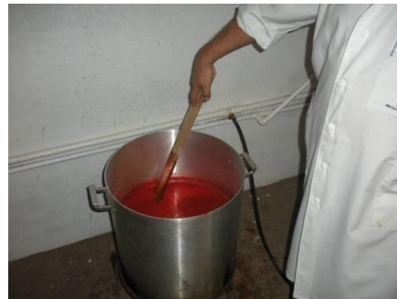
Foto Nº 3: Inactivación enzimática, cocción y concentración del tomate triturado.
