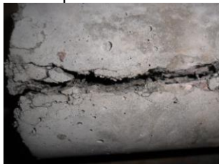
Figura 6: Tipo de rotura. Las partículas de caucho impiden la separación del hormigón en el plano de rotura
