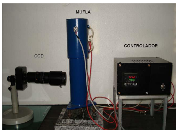
Figura 4: a la izquierda la cámara digital, en el centro la mufla que tiene ranura vidriada a la izquierda; a la derecha el control de temperatura. La computadora de control y el voltímetro con el que se registra la temperatura no se observan.
