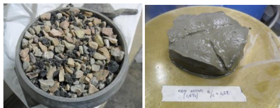
Figura 3. Determinación de la masa por unidad de volumen de la mezcla de agregado grueso y caucho, según proporciones propuestas 90/10 y 85/15%, según IRAM 1548 [5].
