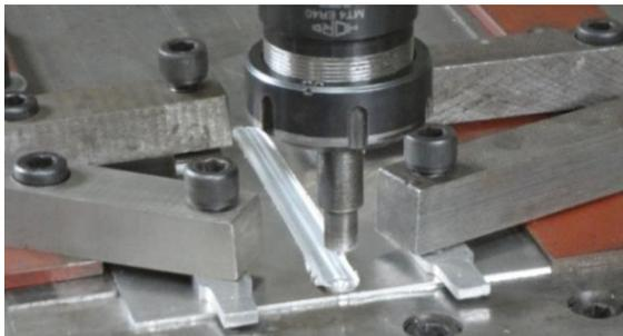
Figura 1: equipamiento utilizado para la FSW.
