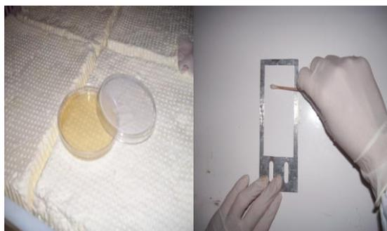
Figura 3: Método sedimentación (izquierda) método hisopado (derecha).
