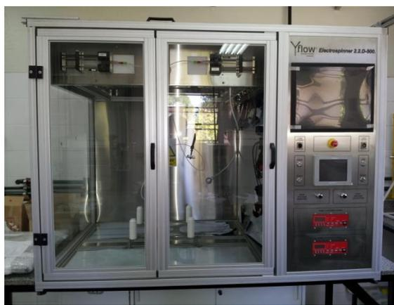
Figura 1. Equipo Yflow Electrospinner 2.2. INTI-Textiles
