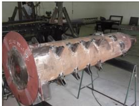
Figura 1: Rotor axial en proceso de ensamble que pasaría a conformar "el corazón" de la cosechadora.
