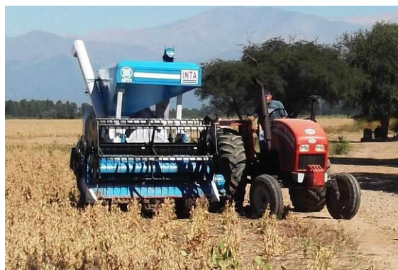
Figura 2: Primer prototipo de la Cosechadora de arrastre fabricada en la ciudad de Palpalá por el grupo MOVAL Máquinas de Jujuy.
