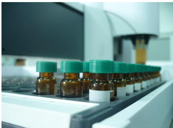
Figura 2: Instrumental utilizado para la determinación de CLA por cromatografía gaseosa
