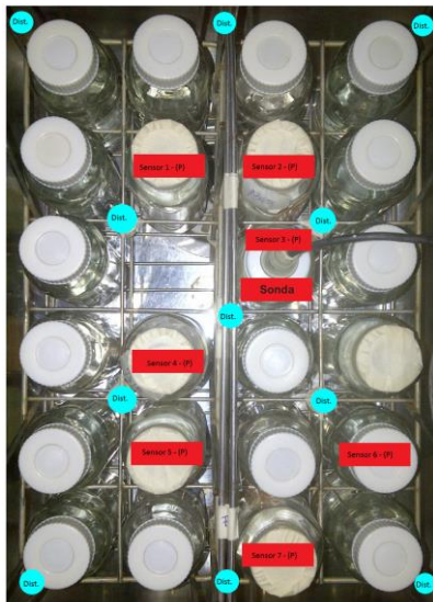
Figura 3: Canastos portabiberones. Ubicación de los sensores de distribución (Círculos celestes) y los de penetración (Rectángulos rojos).
