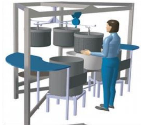
Imagen 3D del diseño final del puesto de teñido.
