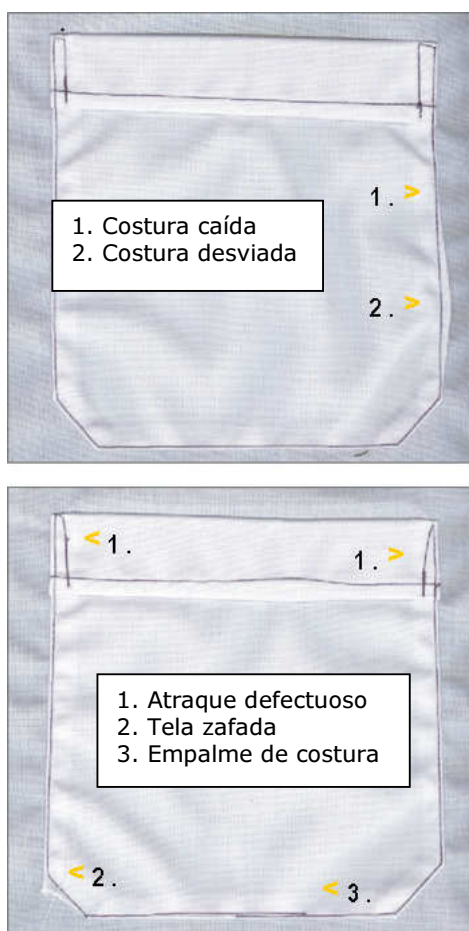
Figura 2 - Muestrario de defectos en costuras. Ejemplo, en bolsillo de prenda.
