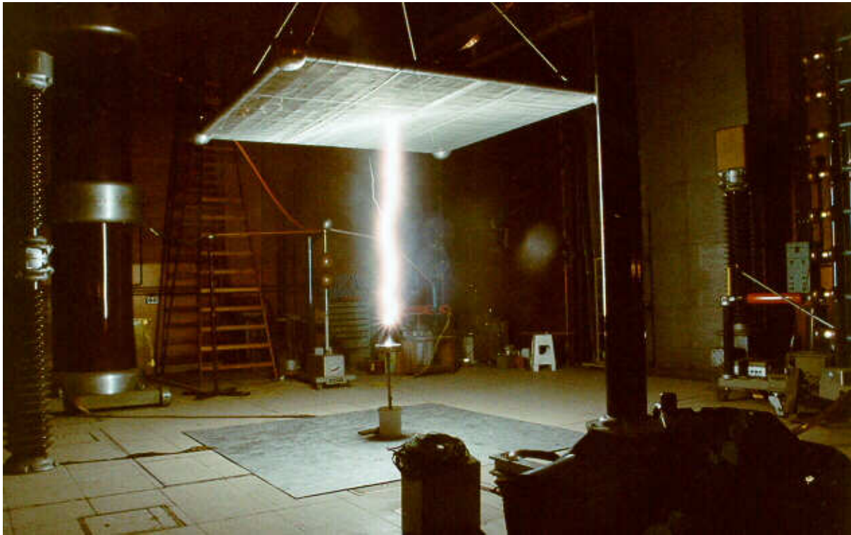
Fig. 2: Descarga de rayo generada en un ensayo de pararrayos con dispositivo de cebado
