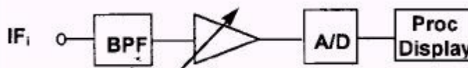
Figura 17: diagrama en bloques de la etapa de filtrado de FI y detección de las señales de los puertos
