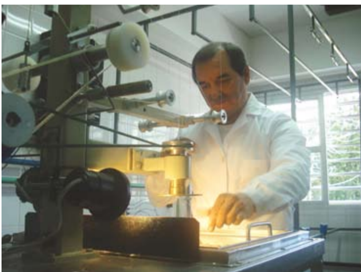
Máquina devanadora de seda de filamento continuo, la primera en el país, desarrollada por el Centro INTI-Textiles.
