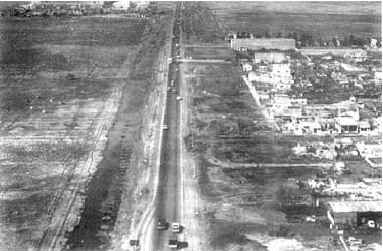
Figura A.1. Ejemplo de terrenos con transición de rugosidad tipo I a tipo III.
