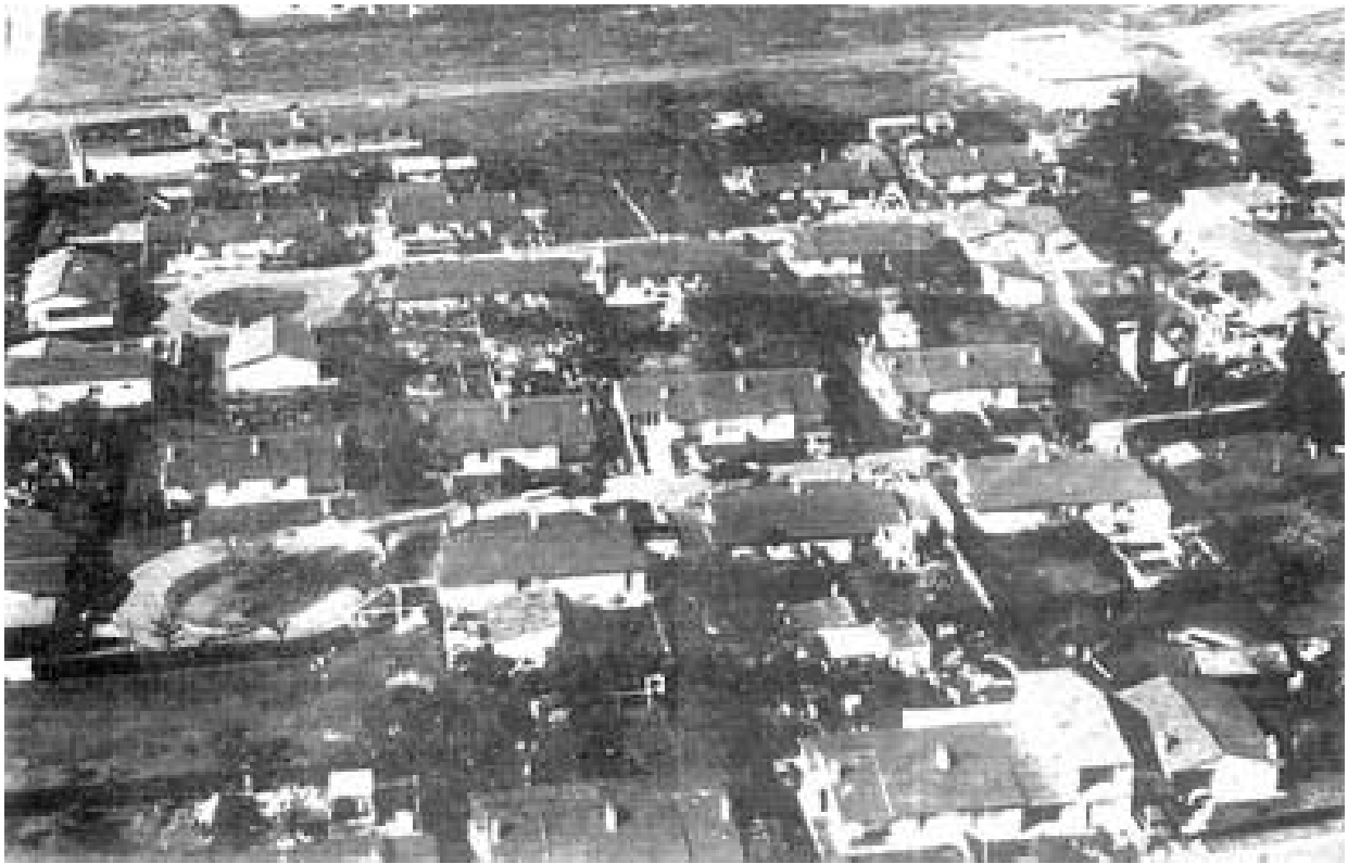
Figura 7. Ejemplo de terrenos con tipo de rugosidad III.
