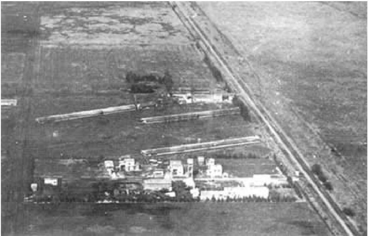
Figura 5. Ejemplo de terrenos con tipo de rugosidad I.
