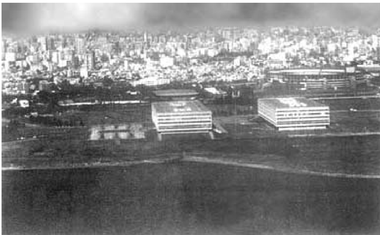
Figura A.3. Ejemplo de terrenos con transición de rugosidad tipo I a tipo II, y a tipo IV.
