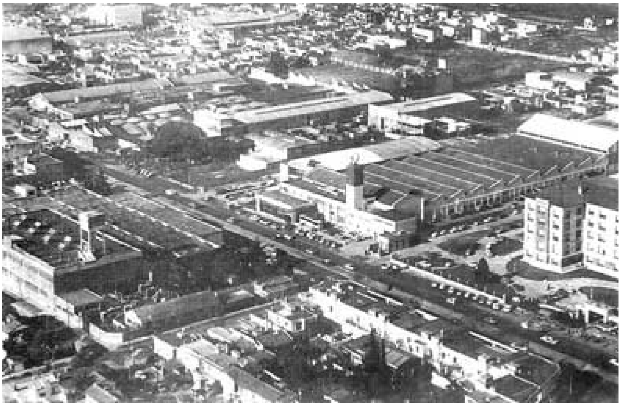
Figura 8. Ejemplo de terrenos con tipo de rugosidad III.
