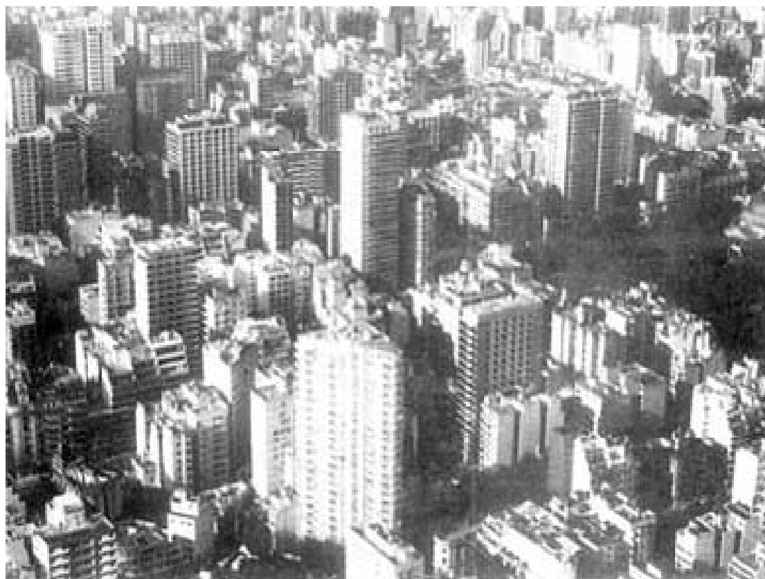
Figura 10. Ejemplo de terrenos con tipo de rugosidad IV.
