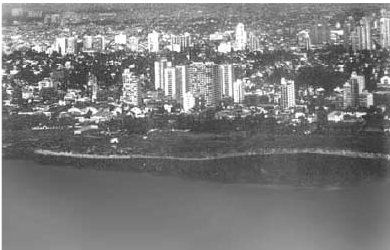
Figura A.4. Ejemplo de terrenos con transición de rugosidad tipo I a tipo II, y a tipo IV.
