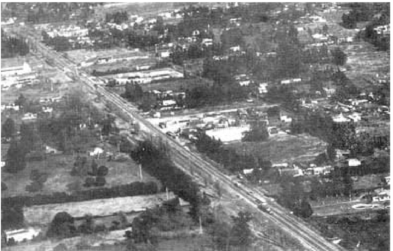
Figura 6. Ejemplo de terrenos con tipo de rugosidad II.
