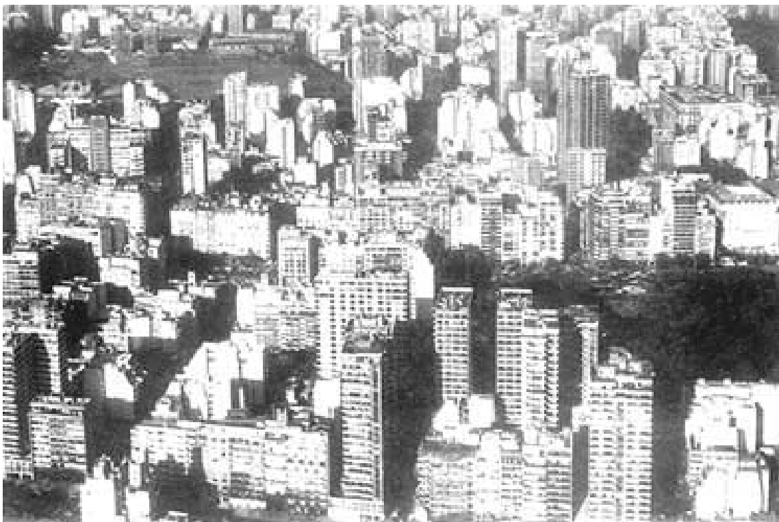
Figura 9. Ejemplo de terrenos con tipo de rugosidad IV.
