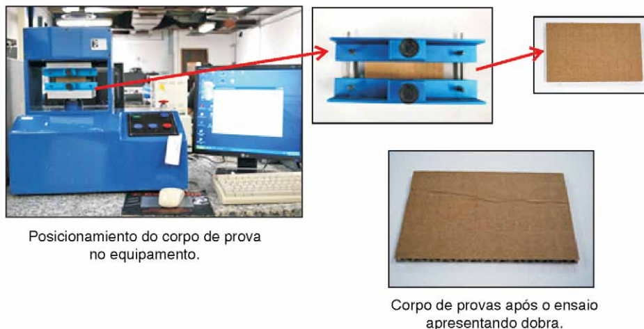
Figura 2: Equipamento para medição da resistência à compressão de coluna.
