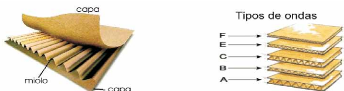
Figura 1: Estrutura das chapas de papelão ondulado.
