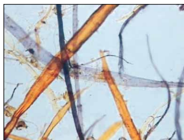
Figura 6: Imagem de fibras presentes em um higiênico folha simples manufaturado com fibras recicladas.
