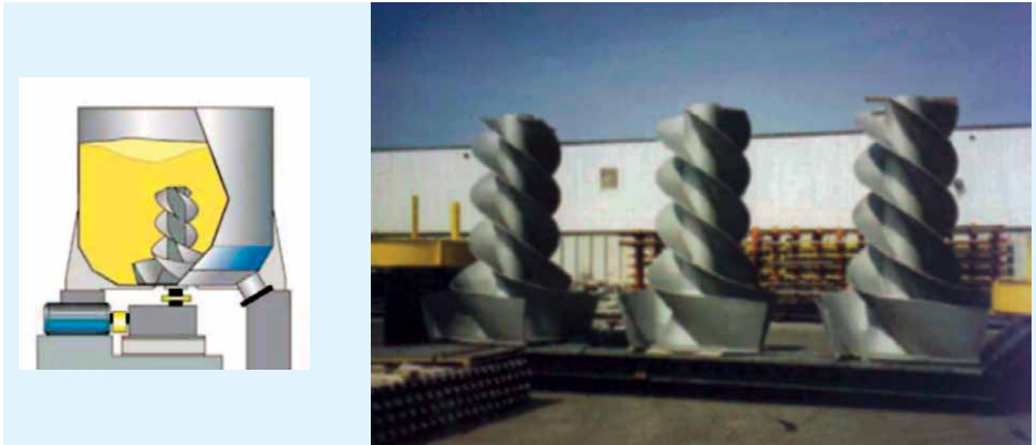
Figura 5: Diagrama de un púlper helico (Andritz, 2011) y fotografía de agitadores helicoidales (Holik, 2000).
