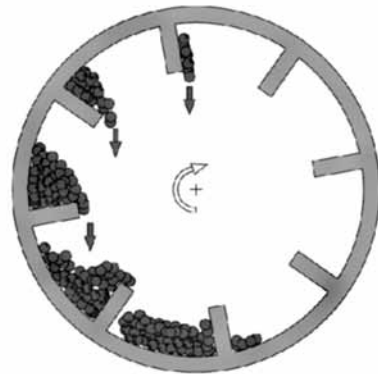
Figura 7: Movimiento de la suspensión en el interior de un púlper tambor (Holik, 2000).
