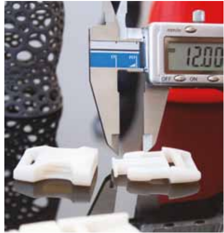
Prueba de funcionamiento de broche-hebilla plástica para mochila deportiva.
