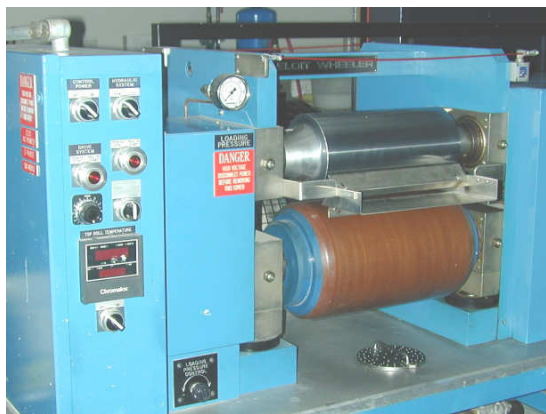
Figura 1 : Calandra blanda de laboratorio utilizada en los ensayos
