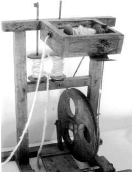
Fig. 2. Rueda de hilatura transversal con carrete chico y sin freno.
