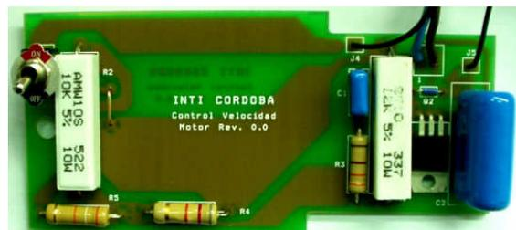
Fig. 5. Placa del control electrónico de velocidad.
