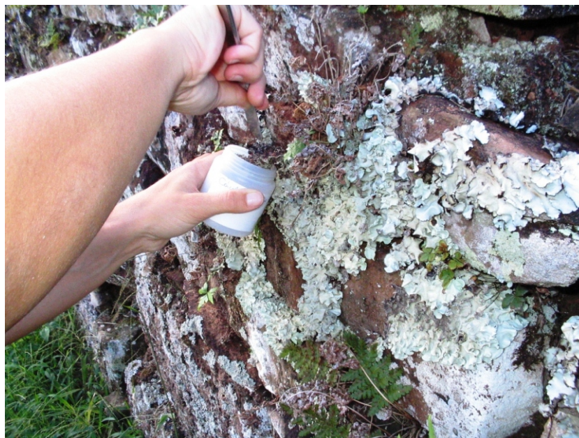
Figura 3: Fotografía de la toma de muestra de una pared externa de la cárcel. Puede observarse sobre la misma un biofilm blanco correspondiente a la presencia de líquenes.
