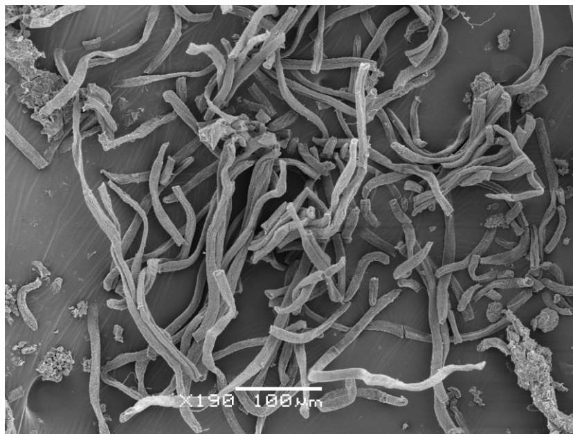
Figura 4: Microfotografía de MEB de la muestra de la Sacristía donde se observan hifas de hongos. Aumento x 190.
