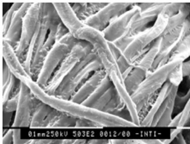
Fig. 6: Microfotografía M.E.B. de un tejido impregnado con microcápsulas de levadura con aceite esencial de limón encapsulado. (500x) a) Sin lavar. b) Luego de un lavado.
