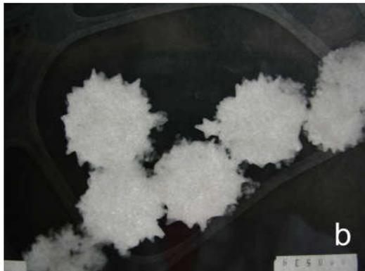
**Figura 4.** Micrografías electrónicas por transmisión de nanopartículas *core-shell*.
